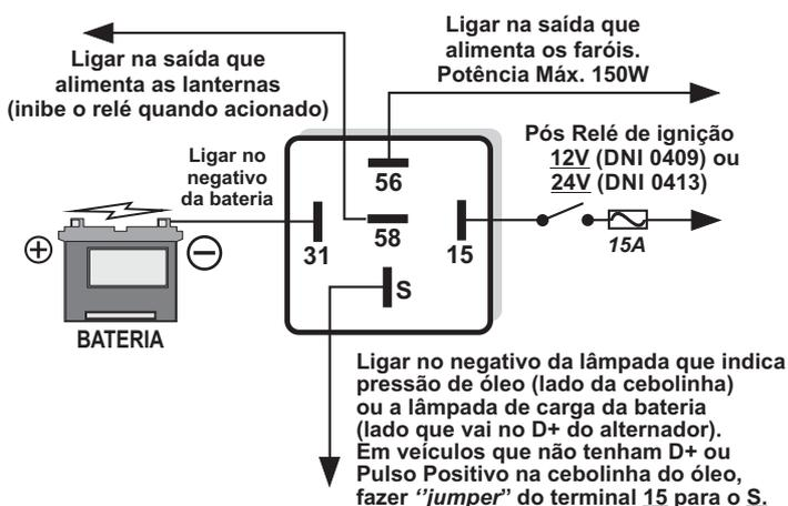
Os relés **DNI 0409 / DNI 0413** foram projetados para oferecer mais segurança e conforto para você nas estradas. Sua função é acender automaticamente os faróis, aproximadamente **15 seg.** após o funcionamento do motor, exceto quando a lanterna estiver ligada. Pode ser aplicado para automatização de funcionamento de vários outros equipamentos no veículo.
